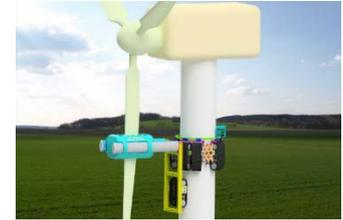
Insbesondere ist es möglich innerhalb der robusten Plattform sowohl Mess-, als auch Reparaturtechnologien, autonom bzw. teleoperativ vom Boden aus durchzuführen und Unfälle mit Personen im Vorfeld zu vermeiden.
